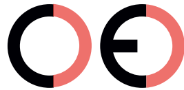
Virheellinen CE-merkki (liian kaukana)
