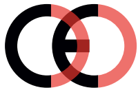
Virheellinen CE-merkki (liian lähellä)
